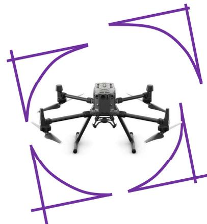
**Euclid** dispose de 2 drones qui peuvent être équipés soit d'un capteur photogrammétrique, soit d'un capteur LiDAR.
